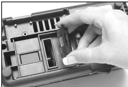
Figura 18. Retire la tapa que se encuentra debajo de la base para limpiar el polvo de metal. (Vea la sección Mantenimiento normal).
