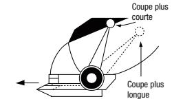
Votre tondeuse peut perdre de la vitesse si des cheveux/poils sont coincés dans les lames. Pour nettoyer les lames sans les démonter, allumer la tondeuse et déplacer la manette de réglage de la hauteur de coupe rapidement de haut en bas plusieurs fois. Cela maintiendra les lames en condition optimale, surtout si vous utilisez beaucoup la tondeuse. Après cela, huiler les lames.
