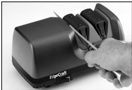
Figure 3. 1ère cellule. Insertion de la lame dans la fente entre le guide et le ressort en élastomère. Alterner dans les fentes gauche et droite.
